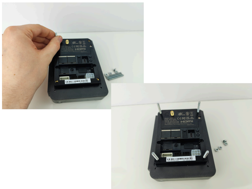
Zdjęcie 10. Umieścić (wkręć) śruby montażowe w obudowę terminala
