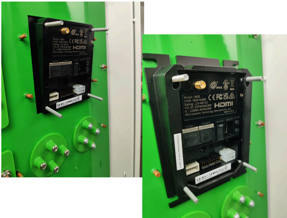
Zdjęcie 11. Umieść terminal w otworze urządzenia, załóż ramkę montażową
